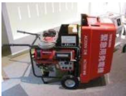
《 非常用発電機 》
