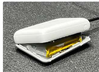
膨張した モバイルバッテリー
