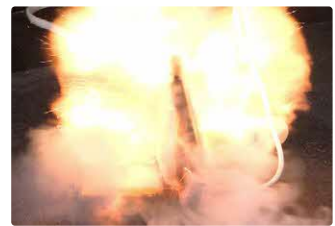
インターネットで購入したモバイルバッテリーが発火した事故の再現
