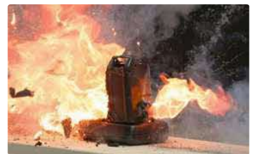
電動アシスト自転車用バッテリーが発火する様子
